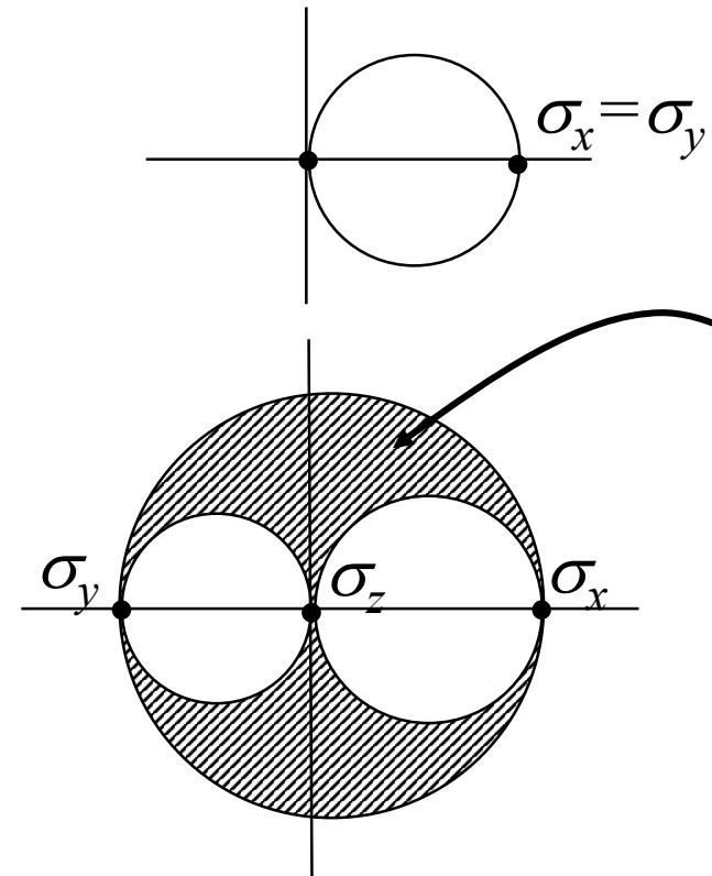
*État de contraintes pour une section tournant autour d'un axe autre que les axes principaux*
